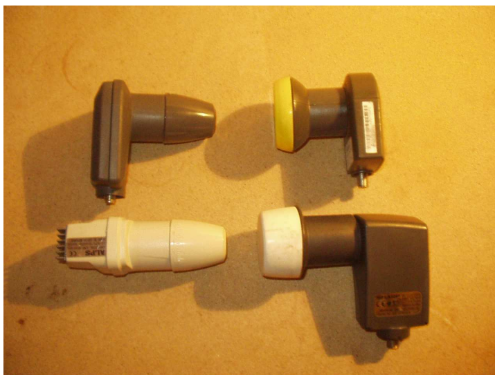
Figura 3. Diversi tipi di LNB.
