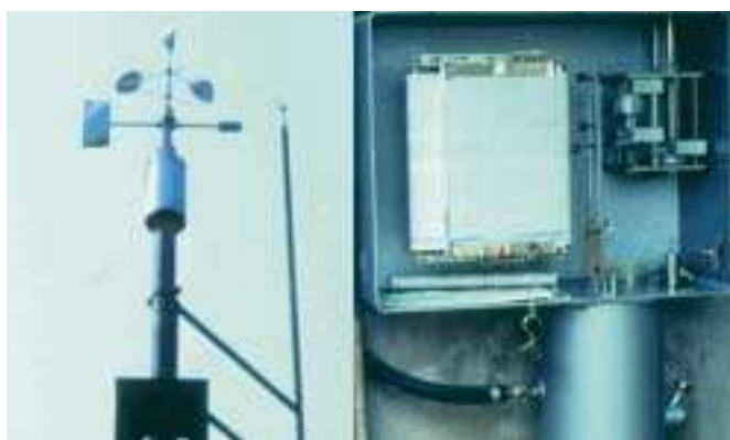
Figura 2. Anemografo universale SIAP usato dal 1938 all'Istituto Talassografico di Trieste.
